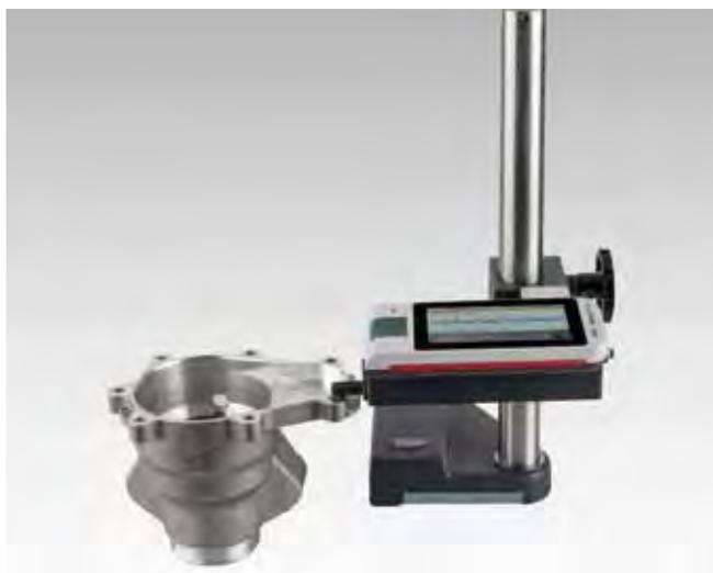
torniti, pezzi rettificati e levigati, su macchine pesanti, pezzi di grandi dimensioni o per il controllo delle merci ricevute. Unico nel suo genere sul mercato con selezione automatica del cut-off, MarSurf PS 10 fornisce risultati di misura corretti anche ai profani della metrologia e quindi la massima precisione.
